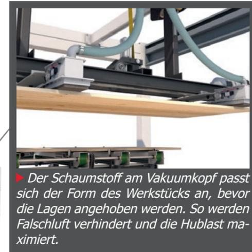
▶ Der Schaumstoff am Vakuumkopf passt sich der Form des Werkstücks an, bevor die Lagen angehoben werden. So werden Falschlufte verhindert und die Hublast maximiert.
