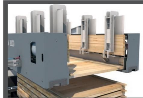
▶ Das mechanische Stapelsystem kann mit optionalen Funktionen wie zum Beispiel Leistenmagazinen ausgestattet werden, die bei Bedarf automatisch Leisten zwischen die Lagen platzieren.
