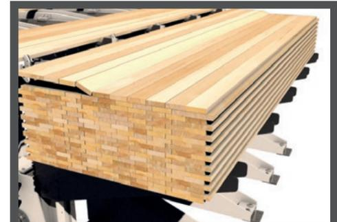
▶ Das mechanische Stapelsystem kann mit optionalen Funktionen wie zum Beispiel einer versetzten Stapelung ausgestattet werden, wodurch eine sehr hohe Stapelung ohne Stabilisierungsleisten ermöglicht wird.
