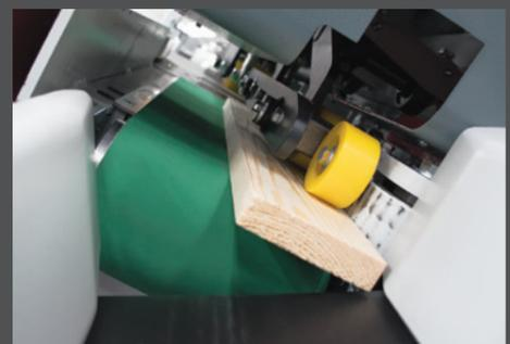
► Integriertes Beschleunigungsband mit angetriebenem Anschlag für eine schnelle, genaue Positionierung der Werkstücke nach der Säge.
