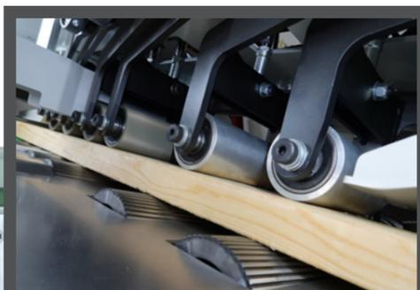
► Die unteren Zufuhrwalzen befinden sich hoch über Grundplatte der Maschine, sodass verzogenes oder krummes Holz zugeführt werden kann, um so maximale Produktivität und Genauigkeit sicherzustellen.
