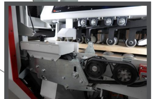
► Der hochwertige, servoangetriebene Zahnriemen der Unterwalzen gewährleistet einen präzisen Schnitt. Seine Konstruktion hat sich als extrem langlebig erwiesen und erfordert nur ein Minimum an Wartung.
