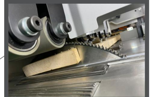
► Das wartungsfreie mechanische Ausschusstor sorgt für eine optimale, einfache Beseitigung kleiner Abfallmengen und defekter Teile in der Säge, sodass die Werkstücke genau sortiert werden können.
