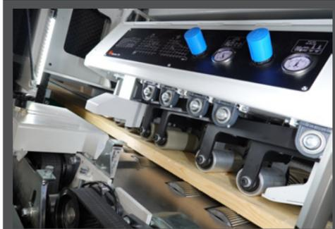
► Eine leistungsstarke Andruckkonstruktion mit starker Doppelseite, gestützt durch Andruckwalzen. Sie gewährleisten maximalen Kontakt zwischen dem Werkstück und der Zufuhrwalze. So wird eine überaus genaue Schnittpräzision bei hoher Beschleunigung und Verlangsamung erzielt.
