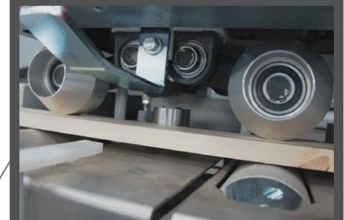
► Integrierte, doppelte obere und untere Walzen für einen genauen Vorschub der Werkstücke.
