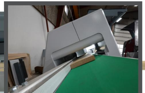
► Das 30°-Winkeldesign der Säge ermöglicht eine sichere Positionierung der Werkstücke während des Sägevorgangs. Werkstücke lassen sich leicht zuführen, und Abfall und defekte Teile werden durch natürliche Schwerkraft beseitigt.
