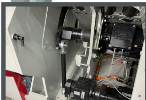
► Die Bewegung des Sägeblatts erfolgt über eine Servo-Nockensteuerung, die jederzeit für eine steuerbare Hochleistung und hohe Schnittqualität sorgt.
