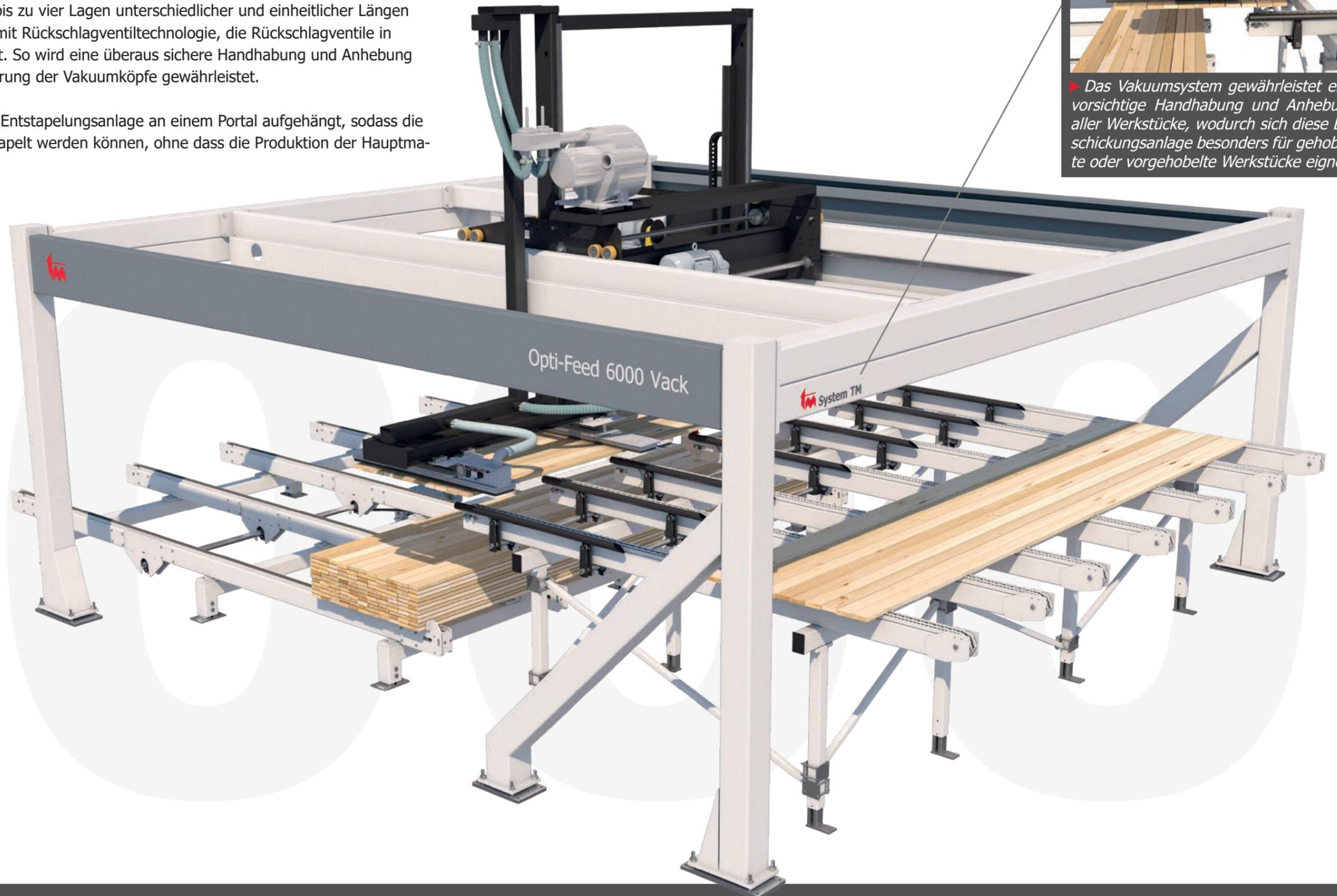
▶ Das Vakuumsystem gewährleistet eine vorsichtige Handhabung und Anhebung aller Werkstücke, wodurch sich diese Beschickungsanlage besonders für gehobelte oder vorgehobelte Werkstücke eignet.
