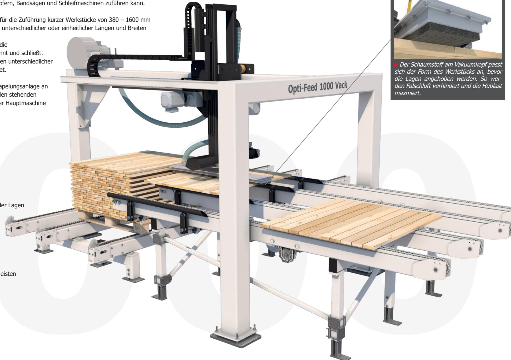
▶ Der Schaumstoff am Vakuumkopf passt sich der Form des Werkstücks an, bevor die Lagen angehoben werden. So werden Falschlufte verhindert und die Hublast maximiert.
