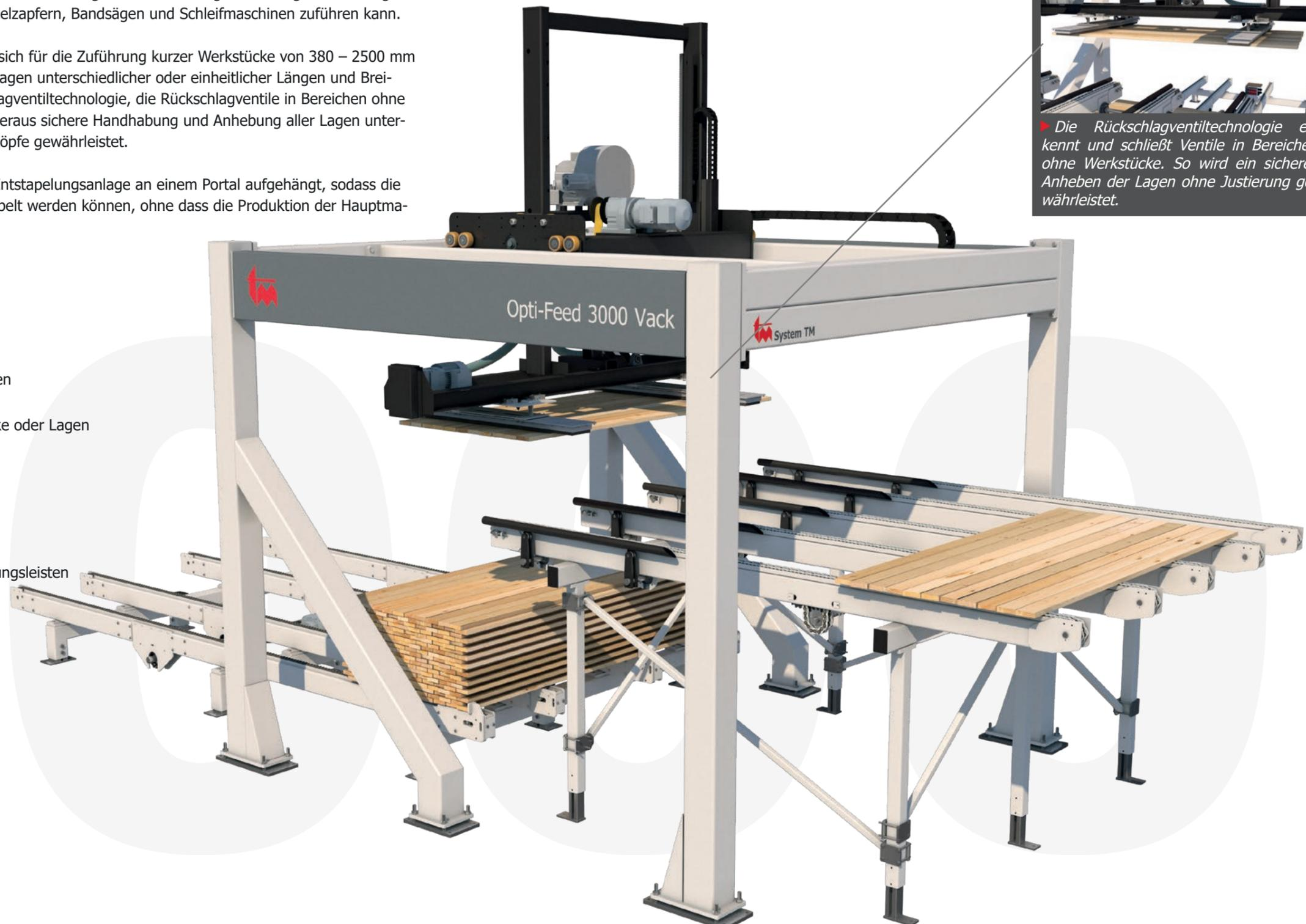
▶ Die Rückschlagventiltechnologie erkennt und schließt Ventile in Bereichen ohne Werkstücke. So wird ein sicheres Anheben der Lagen ohne Justierung gewährleistet.
