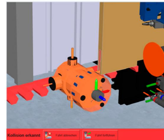
Detección de colisiones en una DRILLTEQ V-310
