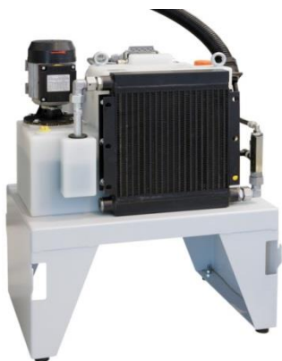
Passive Spindelkühlung für Standard Spindel
