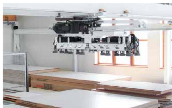
HOMAG bietet standardmäßig zwei Traversenvarianten (ST61 und ST71) für Flächenlager. Beide Traversen sind selbstlernend und generieren die für das Plattenhandling benötigten Daten eigenständig. Darüber hinaus sind sie mit einer integrierten Gewichtskontrolle, Plattenkorrektur und effizienten Vakuumzeugung ausgestattet und sorgen so für präzises, sicheres und effizientes Materialhandling und einen qualitativ hochwertigen und genauen Produktionsprozess.
