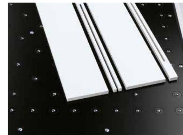
lassen sich schon in der Optimierung vorgeben und nehmen dem Material die Spannung. Gleich mitproduzieren lassen sich mit der Ausschnittfunktion auch Plattenöffnungen und Einsatznuten, wie sie etwa für Küchenspülen oder Türen benötigt werden.
