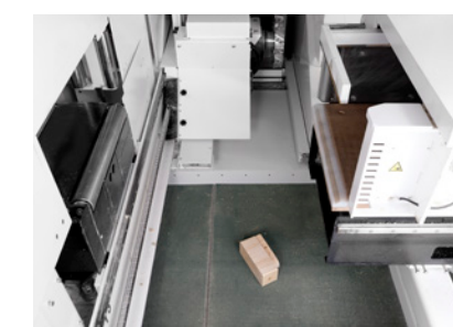
Dopravný pás na triesky je už súčasťou základného vybavenia
