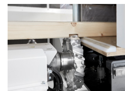
Výroba žľabu kotúčovou frézou
