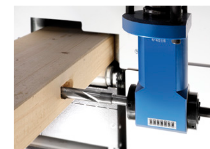
Vytváranie otvorov pre čapy a výrezov
