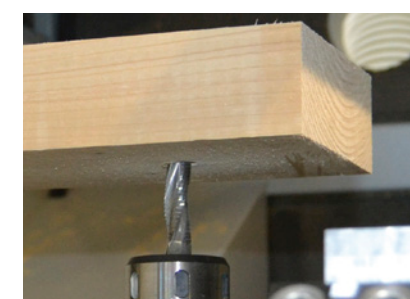
Frézovanie otvorov pre čapy pomocou podúrovňového agregátu
