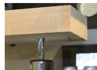
Fraisage de mortaise avec agrégat de fraisage par en dessous
