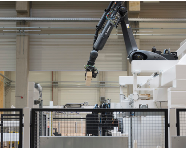
Krótki czas taktu: robot układa słupki w konstrukcji szkieletowej z prędkością sięgającą do 6 taktów na minutę.
