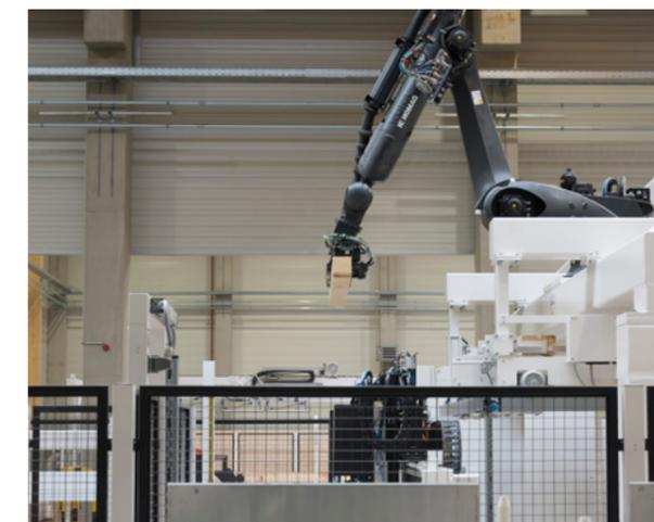
Temps de cycle courts : le robot insère les bois dans l'ossature à une vitesse maximale de 6 cycles par minute.
