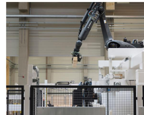
Tiempos de ciclo cortos: El robot coloca las piezas de madera en el armazón a una velocidad de hasta 6 ciclos por minuto.
