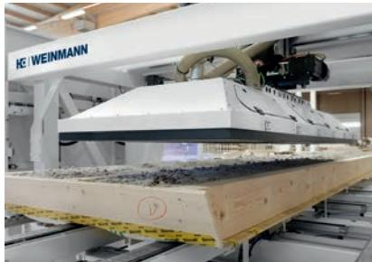
**WALLTEQ M-300 insuFill – станция установки изоляции**
