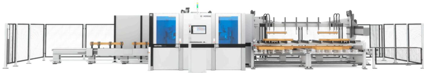
**Nesting**, die Bearbeitung von Plattenelementen auf einer Opferplatte ermöglicht Aufteilen und vertikale Bearbeitungen in einem Schritt durchzuführen. Ideal geeignet für die Fassadenplatten, Beplankungen und Dämmplatten in unterschiedlichsten Ausführungen.
