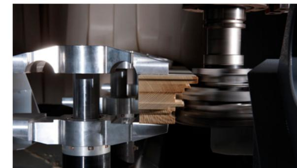
Flüssigkeitsgekühlte Frässpindeln mit Vektorregelung
