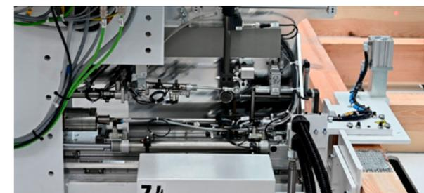
Schraubaggregat zum Verschrauben von Riegelwerken.
