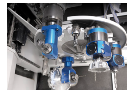
Magazynek do wymiany narzędzi z 12 miejscami
