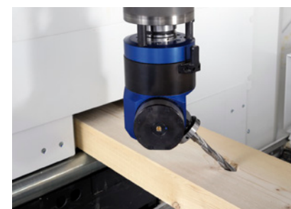
5-osiowa obróbka frezarska
