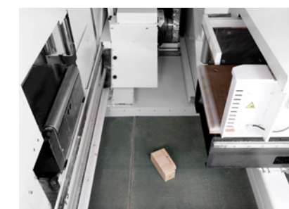
Taśma do transportu wiórów już w wyposażeniu podstawowym
