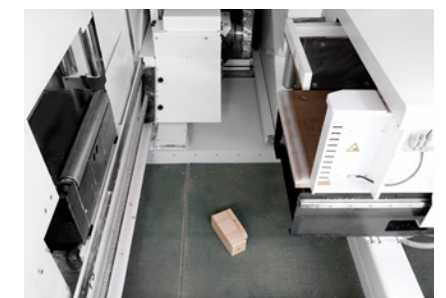
Spänetransportband bereits in der Grundausstattung enthalten
