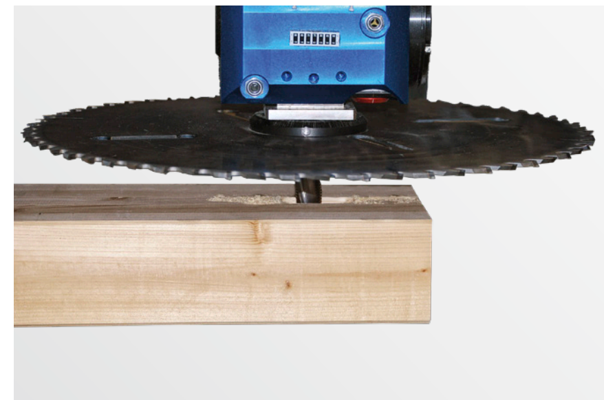
Sägeblatt mit integrierter Fräseraufnahme
