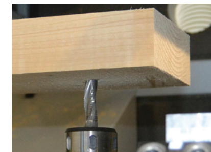
Zapfenloch-Fräsung mit Unterfluraggregat
