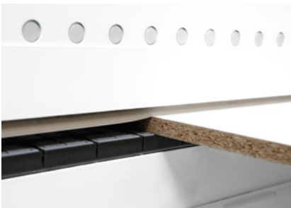
Mecanizado de piezas pequeñas Mayor flexibilidad en la producción, ya que el mecanizado y el guiado de piezas son óptimos también para longitudes de pieza inferiores a 240 mm hasta una longitud mínima de 120 mm. Esto se consigue mediante una estrecha distribución de los rodillos en el prensor superior.
