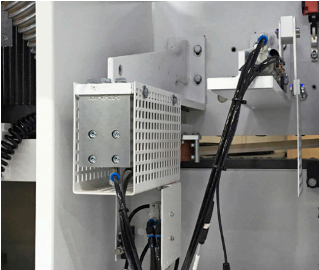
Dispositivo de presión de seguridad Para realizar ranuras en marcha síncrona en listones macizos. En el modelo 1670 FGC.
