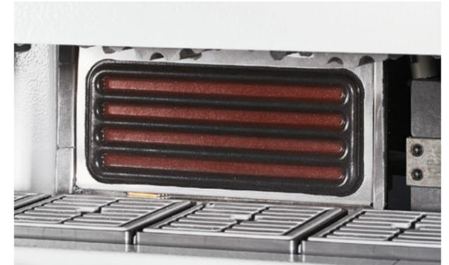
**Werkstückvorwärmung mit Infrarot-Strahler**
