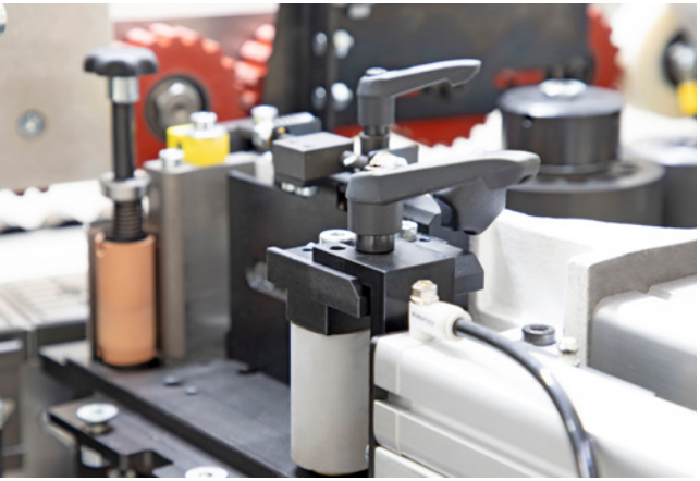
Contre-pression des rouleaux Contre-pression des rouleaux pour matériau de chant sensible.
