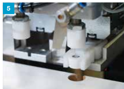
5 Osadzanie łączników w wywierconym otworze za pomocą tłoka
