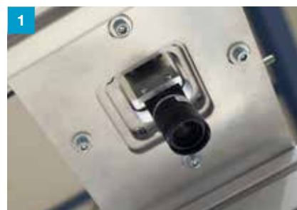
1 Układ kamer wykrywa i weryfikuje położenie łączników
