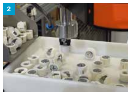
2 Płyta wibracyjna ustawia łączniki w prawidłowym położeniu
