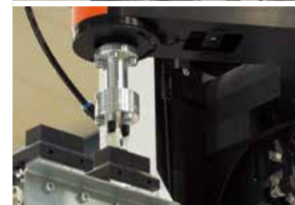
3 Robot separuje łączniki i napełnia magazyn w maszynie
