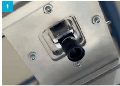
1 Un sistema de cámara detecta y comprueba la posición de los elementos de unión
