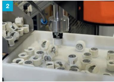
2 La bandeja vibratoria gira los elementos de unión a la posición correcta
