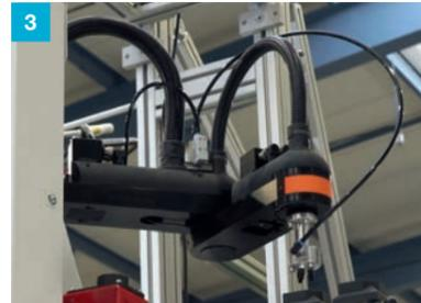
3 El robot separa los elementos de unión y rellena los cargadores de la máquina pretaladrada
