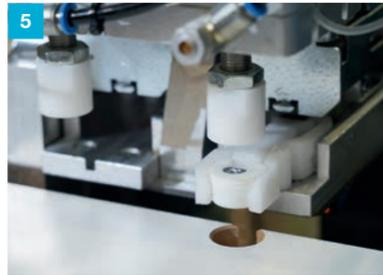
5 Inserción a presión con un émbolo de los elementos de unión en la posición pretaladrada
