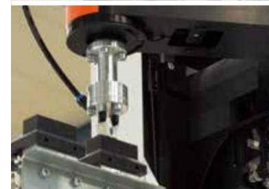
Le robot sépare les connecteurs et les place dans les magasins de la machine.
