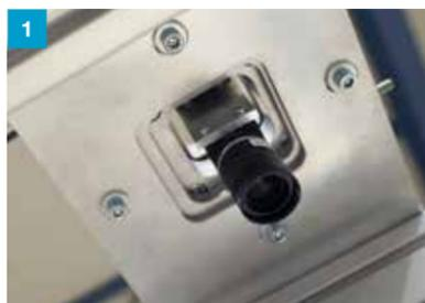
Un système de caméra détecte et contrôle la position des connecteurs.
