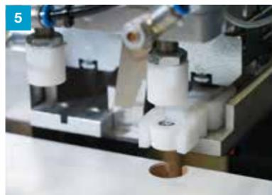
Insertion des connecteurs dans la position pré-percée au moyen d'un tampon.
