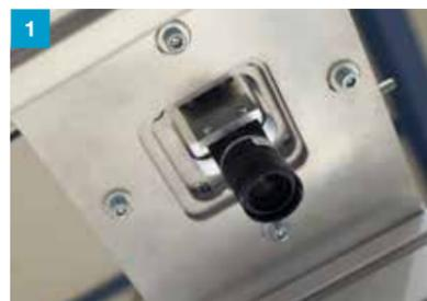
Un sistema con fotocamera rileva e verifica la posizione delle giunzioni
