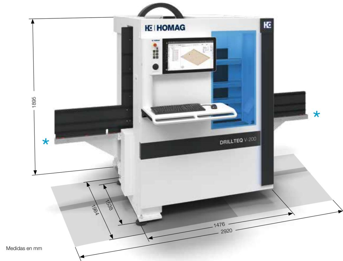
\* Debe mantenerse una distancia de seguridad proporcional en el sentido de entrada y de salida (nota de la documentación).
