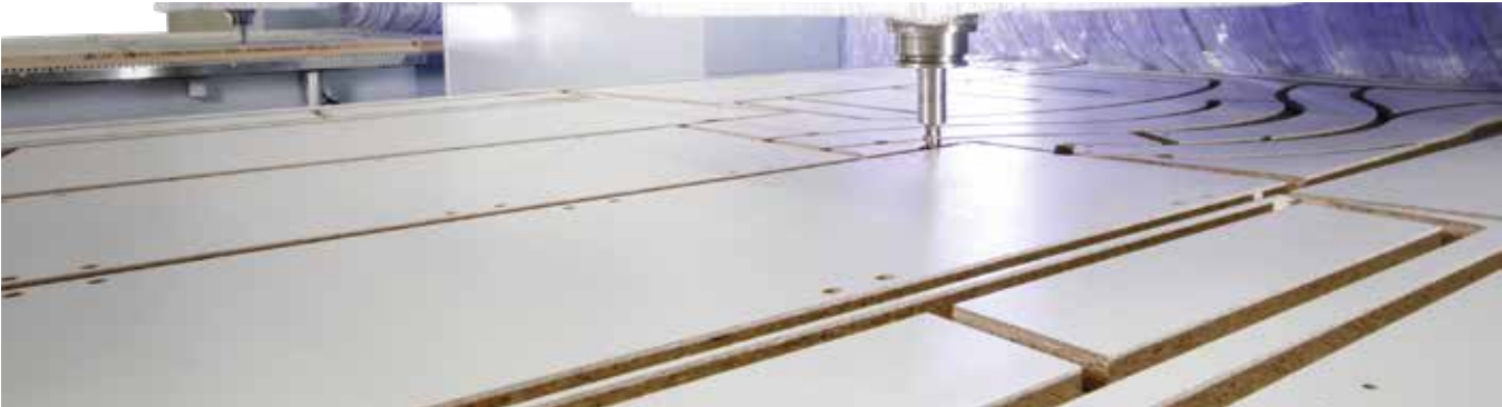
Lavorazione nesting: taglio e lavorazione dei pezzi all'interno del pannello minimizzano lo scarto
