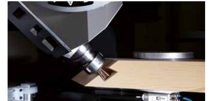
Fresatura di giunzioni tra montanti e traverse
