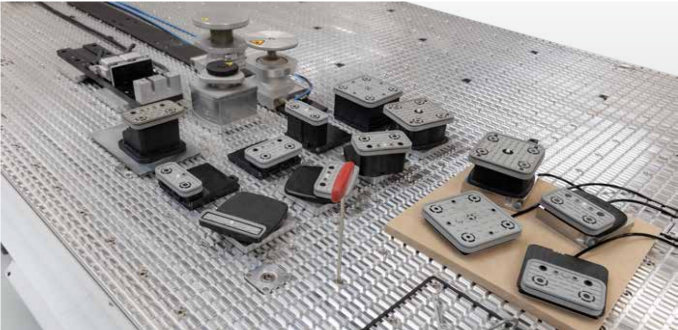
Ventose a depressione Dispositivi di bloccaggio a depressione per l'inserimento nelle scanalature del tavolo a reticolo
