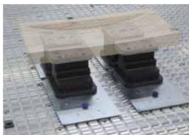
**Système Maxi-Flex** : panneau système à équiper librement pour le système de serrage par le vide.
