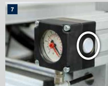
**Boutons de démarrage du programme** – un bouton sur les profils de butée gauche et droit sert à démarrer le programme d'usinage.
