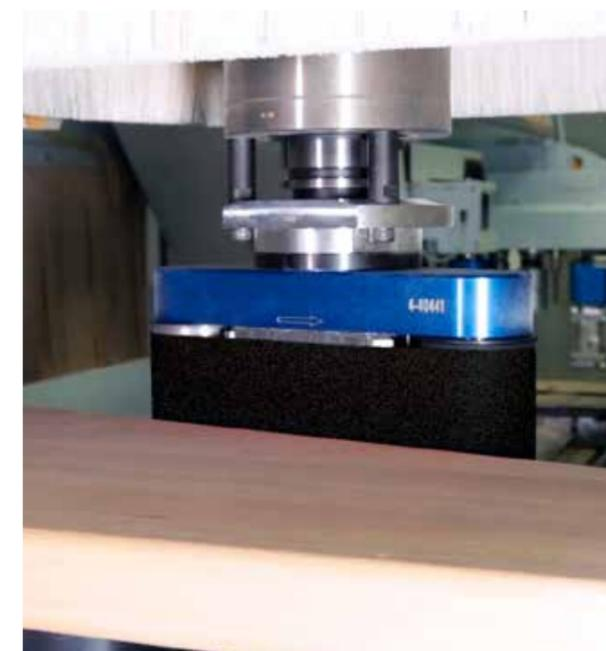
**Interface pneumatique** : l'interface avec support 3 points sur tous les axes C et en option sur le DRIVE5CS permet l'utilisation d'agrégats à palpement, p. ex. pour un arrondissement supérieur et inférieur précis, indépendamment des tolérances d'épaisseur.
