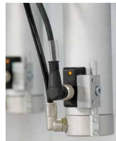
**Contrôle électronique de la position finale :** sécurité accrue grâce au contrôle électronique de la position finale sur tous les vérins de butée.
