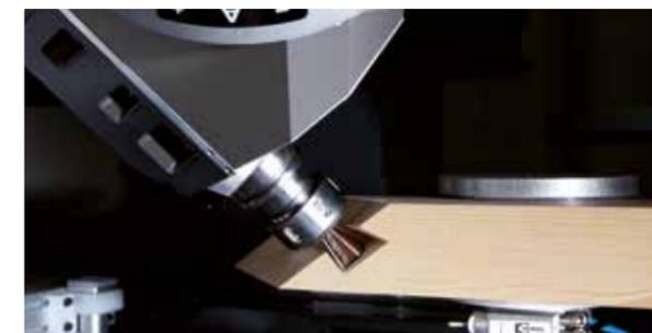
Fraisage de raccord d'arêtes pour structures de poteaux/barres
