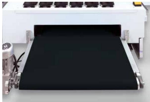
**Transport des copeaux (en option)** : large convoyeur de copeaux intégré pour une élimination facile des chutes et des copeaux.
