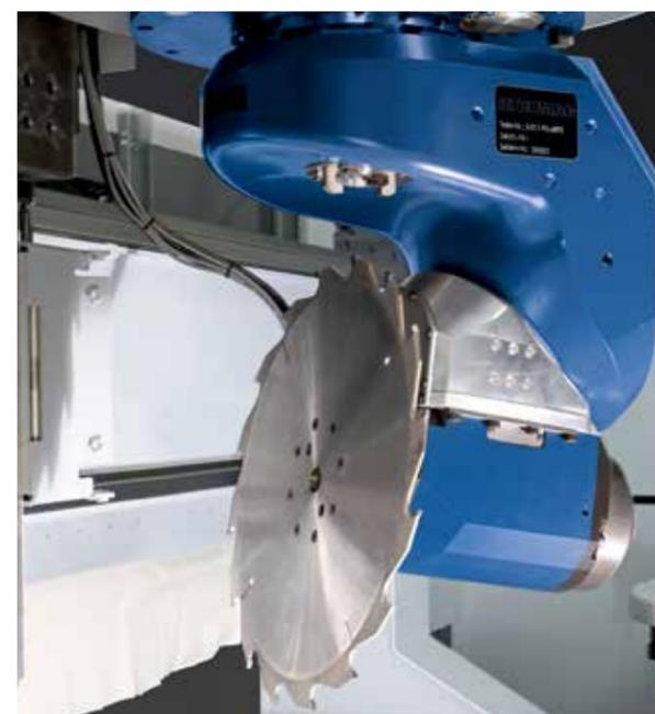
**Tête intelligente 5 axes DRIVE5CS** : conception compacte et trajets de force réduits. Une dose maximale de technologies dans un espace réduit, mais sans limitation des possibilités d'usinage. Broches à refroidissement liquide d'une puissance de fraisage de 10 kW (12 kW en option) pour un travail efficace. La conception compacte optimise l'espace de travail (p. ex. avec une lame de scie de 350 mm sous le capot).
