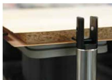
**Système de butée (arrière, avant et latéral) :** axes de butée massifs, abaissables par système pneumatique, avec contrôle électronique de la position finale.
