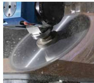
**Sciage, fraisage, perçage quelque soit l'angle : agrégat FLEX5** avec réglage d'angle automatique. Un agrégat unique pour les broches 4 axes qui couvre plus de 90 % des applications 5 axes.
