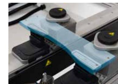
**Système de serrage multiple :** p. ex. pour des pièces étroites et des cadres.
