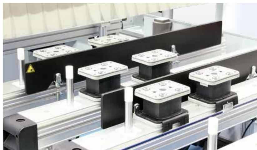
**Aides au positionnement :** aides au positionnement robustes pour l'introduction de pièces lourdes avec 2 vérins pneumatiques. Le mouvement linéaire des aides au positionnement garantit une mise en place sûre des pièces, que l'usinage soit effectué sur les butées avant ou arrière.
