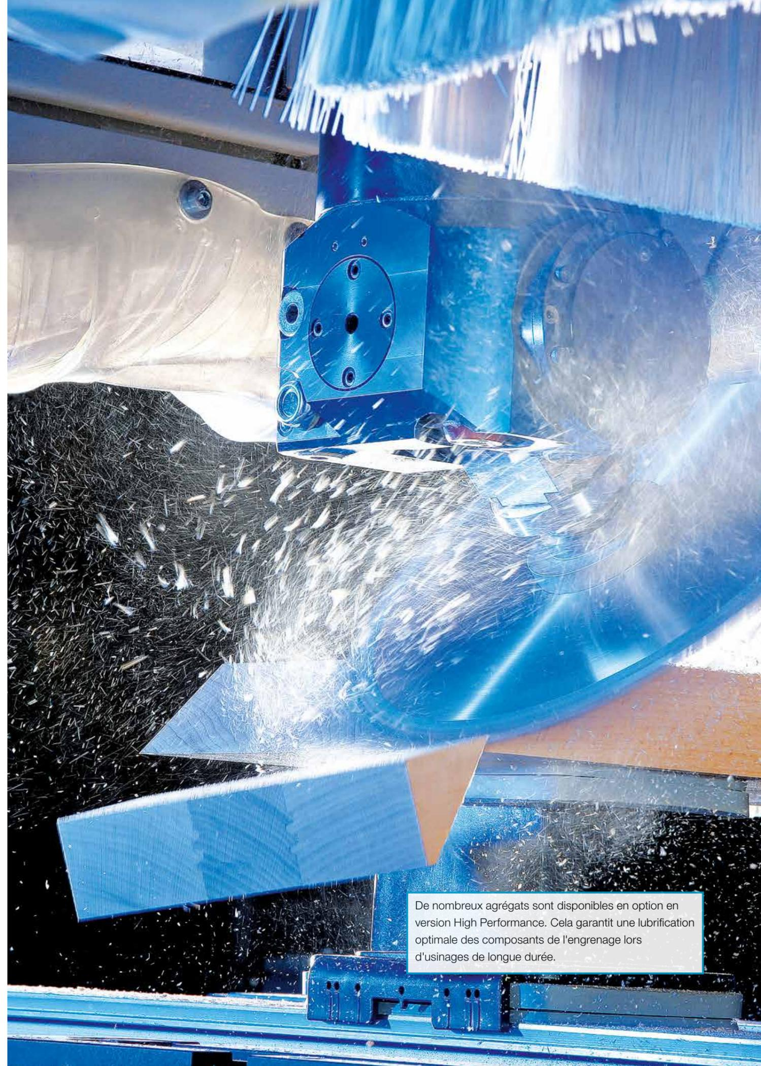
De nombreux agrégats sont disponibles en option en version High Performance. Cela garantit une lubrification optimale des composants de l'engrenage lors d'usinages de longue durée.
