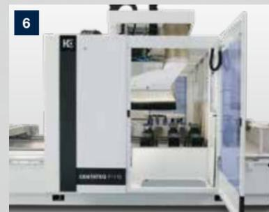
**Visibilité parfaite** dans la machine et protection optimale de l'opérateur grâce au grand hublot. Le changement de mèche et la maintenance peuvent être effectués facilement à l'avant de la machine.
