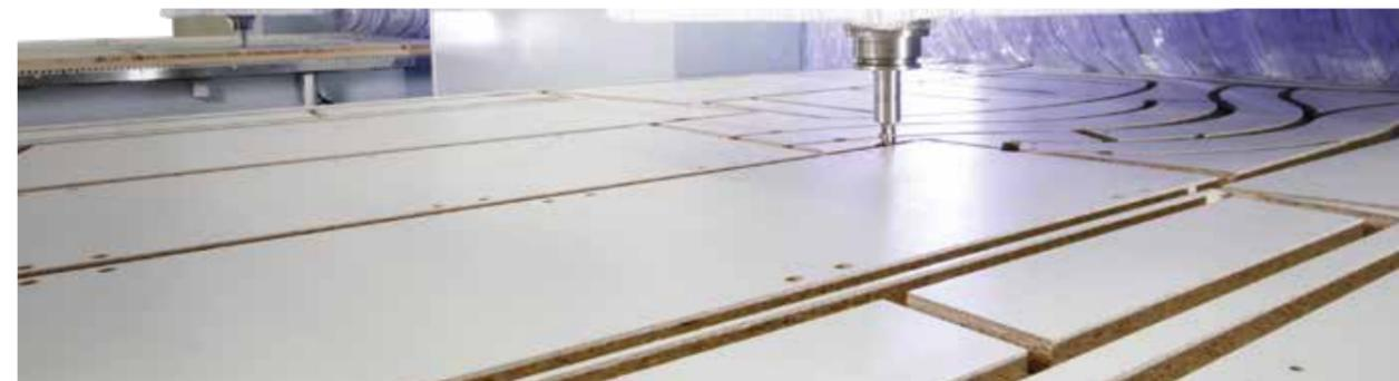
**Usage Nesting** de panneaux : découpe optimisée et usinage dans la surface
