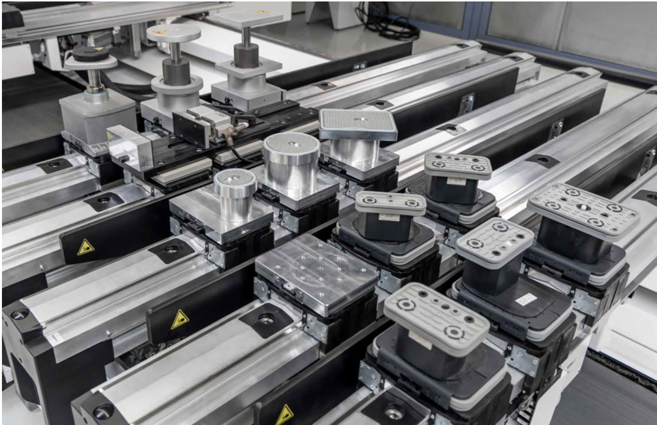
Vákuové upínadlá so snímacím ventilom – neobsadené prísavky môžu zostať na základni. Montážna výška 100 mm
