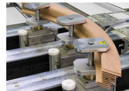
3-stupňové upínadlá: Vysoko pevné 3-stupňové upínadlá s veľkou upínacou výškou na presné kompletne obrábanie dielov okien a domových dverí bez následného prekladania.
