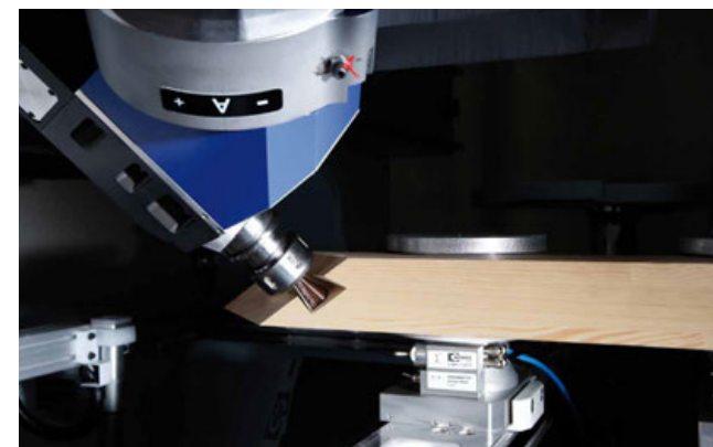
Frézovanie drážkového spoja pre stĺpikové/priečnikové konštrukcie
