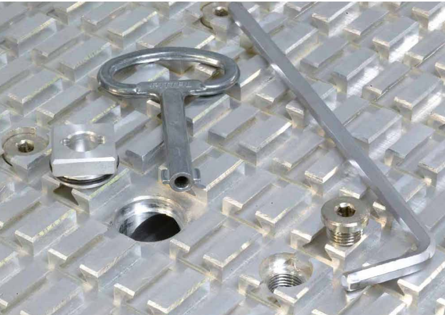
1" vákuové prípojky s rýchlym otváraním pomocou kľúča z elektroozvážacej skrine, vákuové otvory s jemným závitom na upevnenie upínacích prvkov
