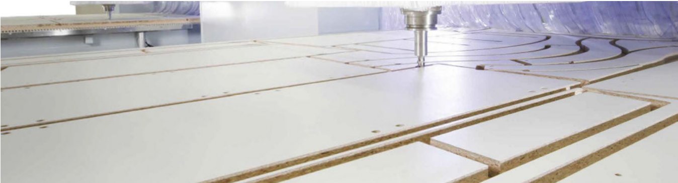
Nestingové obrábanie doskových materiálov: Optimalizované delenie a obrábanie na povrchu s optimalizáciou odpadu
