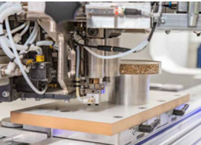
Olepovačka hrán PowerEdge Pro Duo Edge – jeden agregát na všetky požiadavky. Technológia nulovej škáry a presné snímanie sa postarajú o perfektné výsledky pri 360° lepení.
