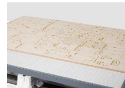
Matricová doska adaptéra poskytuje bezpečné fixovanie aj pri jemných obrobkoch. S matricovou doskou adaptéra je možné aj na stroji s konzolovým stolom „prerezať“ tvarované diely procesom Nesting s optimalizáciou rezu.
