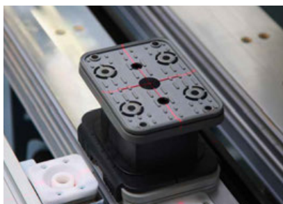
LASEROVÁ polohovacia pomôcka – vákuové prísavky sú zobrazené laserovým terčom s krížom. Obrys obrobku môže byť „obehnutý“ ako polohovacia pomôcka pre obrobky ľubovoľného tvaru.
