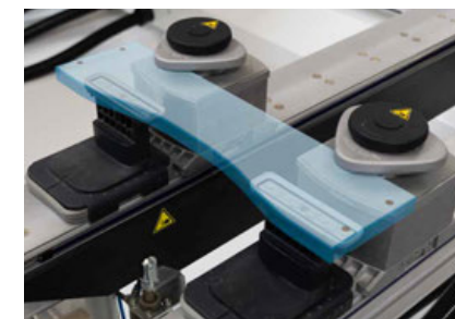
Univerzálne upínadlá pre dvojokruhový vákuový systém. Vákuovo aktivovaný upínací prvok na upínanie líst a hranolkov.
