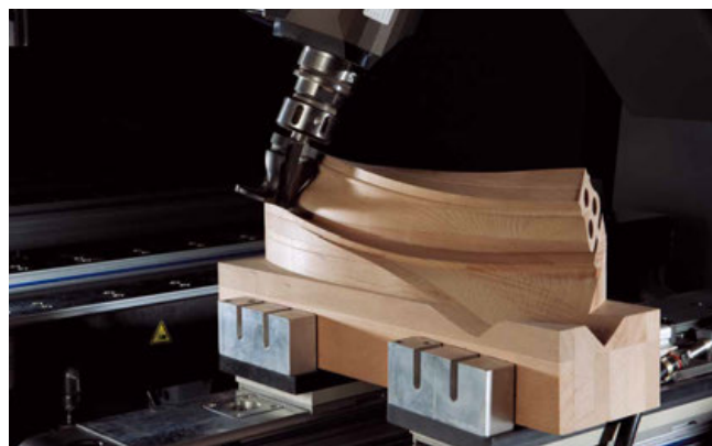
Frézovanie schodiskového držadla
