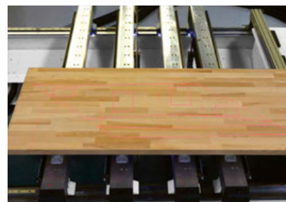
Laserová projekcia upínacieho prostriedku a kontúry obrobku pre optimálne využitie a jednoduché umiestnenie polotovarov, ktoré nie je možné vyrovnáť na dorazoch.
