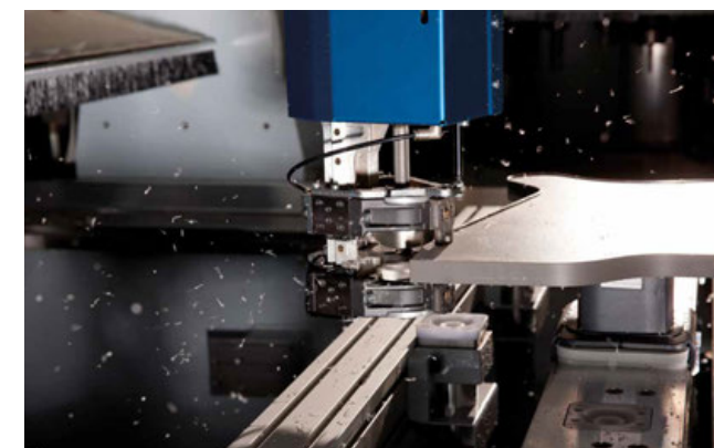
Dokonalé zakončenie hrán vďaka kopírovaciemu kombi agregátu na frézovanie do roviny/finišovanie
