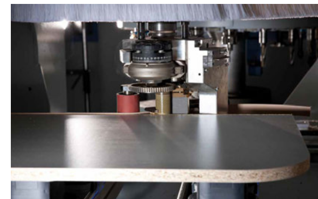
Olepovačka hrán easyEdge na racionálne lepenie na tvarové diely
