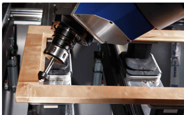
Frézovanie rohu skleneného rámu
