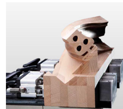
Upínacie zariadenie zaisťuje bezpečné a rýchle upnutie dosák a hranolov.
