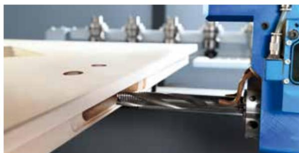
Fresatura serrature di porte
