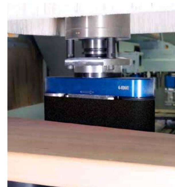
**Interfaccia pneumatica** – l'interfaccia con sostegno a 3 punti per aggregati permette l'impiego di aggregati con tastatore p.es. per la sagomatura precisa da sopra e sotto, indipendentemente da eventuali tolleranze di spessore.
