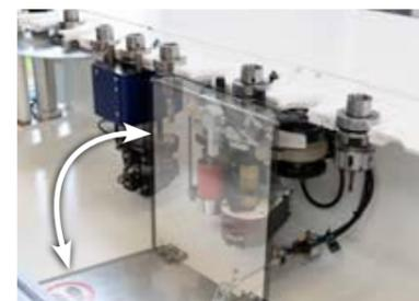
**Interfaccia elettronica** per il dispositivo di cambio lineare laterale per il riscaldamento simultaneo del gruppo di incollaggio bordi.
