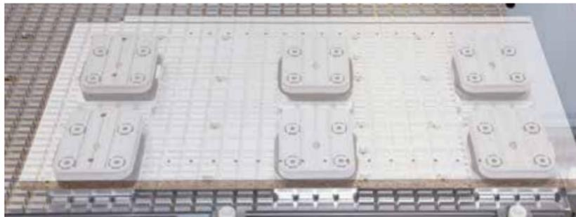
**Ventose a depressione** Dispositivi di bloccaggio a depressione per l'inserimento nelle scanalature del tavolo a reticolo
