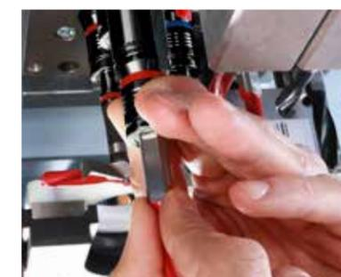
Sistema di cambio rapido per un cambio della punta senza necessità di chiavi e per ridurre quindi i tempi di attrezzaggio.
