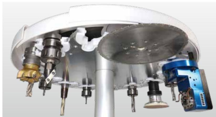
**Magazzino utensili a 14 posizioni,** mobile in direzione X. Anche per lame con un diametro fino a 300 mm.
