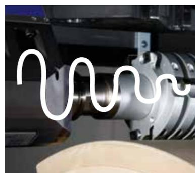
**Raffreddamento a liquido e sensore per oscillazioni (in opzione per DRIVE5CS)** – mandrini a fresare raffreddati a liquido e con cuscinetti ibridi offrono una elevata durata. Un sensore delle oscillazioni supplementare riconosce problemi di bilanciamento degli utensili e protegge il mandrino da sovraccarichi causati p.es. da avanzamenti troppo elevati.
