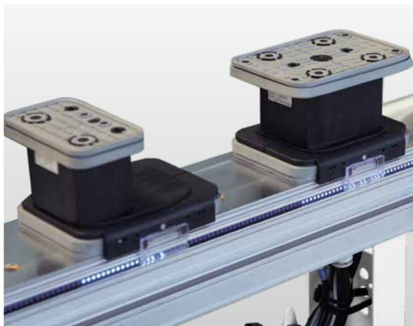
**Sistema a LED** – attrezzaggio rapido e sicuro. Le strisce luminose a LED indicano sia il tipo di ventosa che il suo orientamento, nonché la posizione delle ventose e delle traverse.
