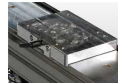
**Piastra base** da fissare sulla traverse come base per dispositivi di bloccaggio speciali.
