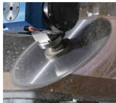
**Sezionatura, fresatura, foratura con qualsiasi angolatura – gruppo FLEX5+** con regolazione automatica dell'angolazione. Un gruppo eccezionale per mandrini a 4 assi che consente di eseguire il 90% delle lavorazioni a 5 assi.
