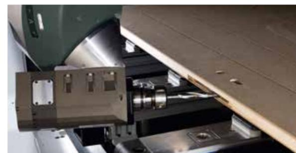
Fresature di serrature di porte
