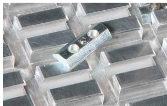
T-gleufmoeren met schroefdraad voor vormsluitende fixatie van spaninrichtingen in de zwaluwstaartgeleiding
