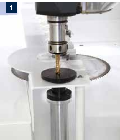
Gereedschapslengtecontrole (optioneel) ▪ Geschikt voor lengtemeting van schachtgereedschappen ▪ Na het uitwisselen van het gereedschap via de uitrustingsplaats wordt een lengtecontrole uitgevoerd en met de gereedschapsdatabase getrimd
