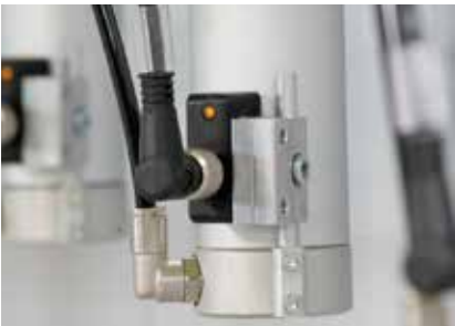
Elektronische eindpositievraag Verhoogde veiligheid door een elektronische eindpositievraag op alle aanwezige aanslagcilinders
