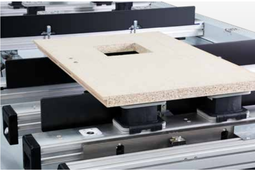
Werkstukinlegsteunen Robuuste inlegsteunen voor het opnemen van zware werkstukken met 2 pneumatische cilinders. Door de lineaire beweging van de inlegsteunen worden de werkstukken bij het neerlaten niet van de aanslagen weggetrokken, ongeacht of deze bij de voorste of achterste aanslagen worden bewerkt.
