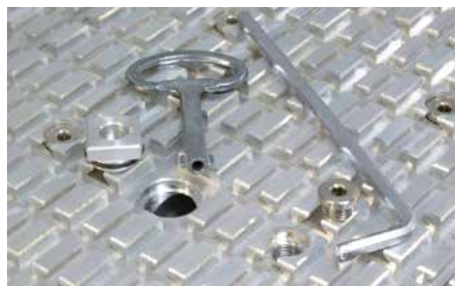
1" vacuümaansluitingen met snelle opening door middel van schakelkastsleutel, vacuümopeningen met fijne schroefdraad voor het bevestigen van spanmiddelen
