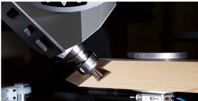
Fräsen einer Gratverbindung für Pfosten-/Riegelkonstruktionen
