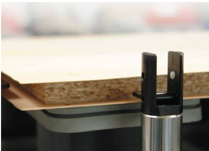
Anschlagbolzen für Deckschichtüberstand mit Endlagenüberwachung zum Schutz von Werkzeugen, Aggregaten und Maschinenbedienpersonal.
