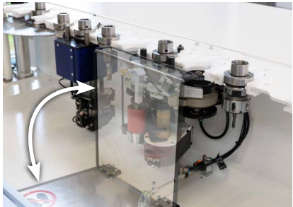
Elektroschnittstelle für den seitlichen Linearwechsler zum zeitparallelen Aufheizen des Kantenanleimaggates.
