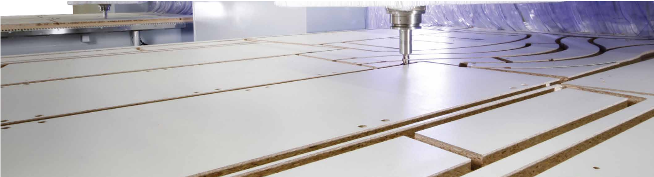
Nesting-Bearbeitung von Plattenwerkstoffen: Verschnittoptimiertes Aufteilen und Bearbeiten in der Fläche
