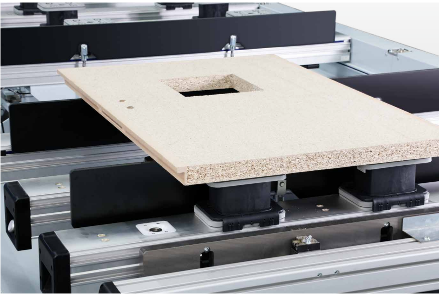
Werkstückeinlegehilfen Robuste Einlegehilfen zum Belegen schwerer Werkstücke mit 2 Pneumatikzylindern. Durch die lineare Bewegung der Einlegehilfen werden die Werkstücke beim Absenken nicht von den Anschlägen weggezogen, egal, ob an den vorderen oder hinteren Anschlägen bearbeitet wird.
