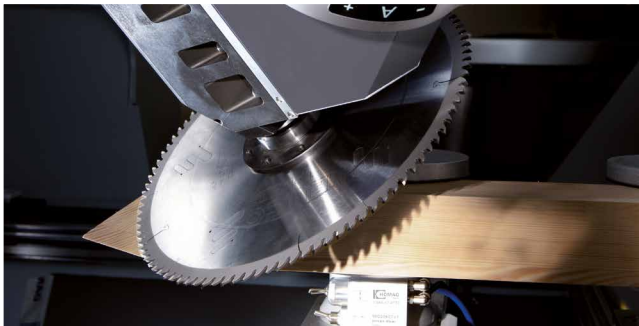
Schifferschnitt mit großer Schnitttiefe für Rahmenteile
