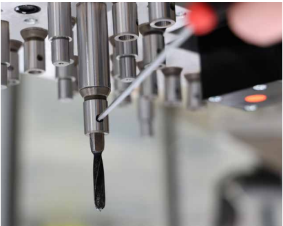
Weldon Wechselsystem für einen Bohrerwechsel mit Werkzeugen
