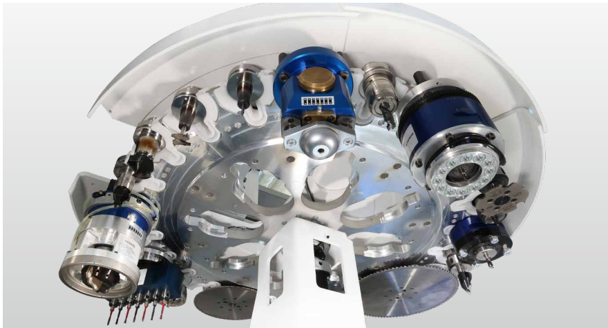
24-fach Tellerwechsler in X-Richtung, mitfahrend. Große Speicherkapazität mit schnellem Zugriff. Auch für Sägeblätter mit einem Durchmesser bis zu 300 mm.
