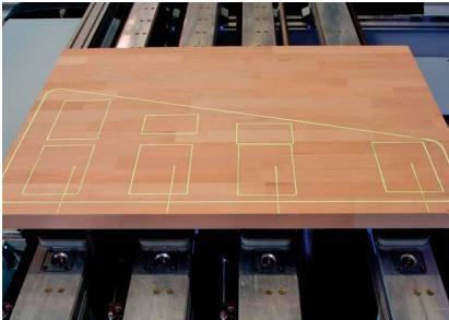
Laserprojektion der Spannmittel und der Werkstückkontur für optimale Ausnutzung und einfaches Auflegen von Rohteilen, die nicht an den Anschlägen ausgerichtet werden können.
