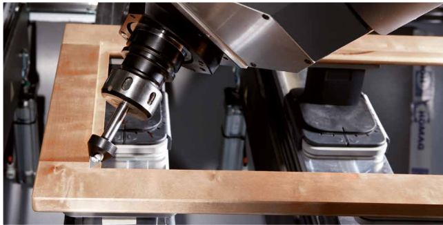
Eckiges Ausspitzen einer Glasfalz-Ecke
