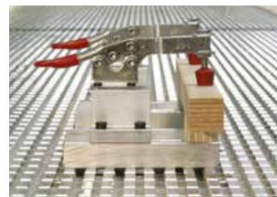
**Fijación de los medios de fijación especiales:** la mesa tramada de aluminio con guías de cola de milano garantiza la fijación precisa de los elementos de sujeción con arrastre de forma
