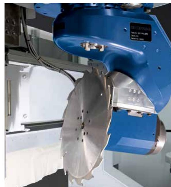
**El inteligente cabezal de 5 ejes DRIVE5CS** tiene un diseño más compacto con trayectorias de fuerza cortas. Mucha tecnología en un espacio pequeño sin limitaciones en la gama de mecanizados. Husillos refrigerados por líquido con una potencia de fresado de 10 kW (12 kW opcionales) para trabajos exigentes. El reducido diseño ofrece más espacio para mecanizar (por ejemplo, con una hoja de sierra de 350 mm debajo de la capota).
