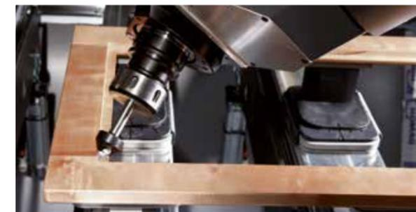
Recortes en ángulo de esquinas para los canales del cristal
