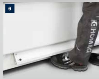
**Regleta de conmutación en lugar de interruptores de pedal.** No es necesario buscar ni desplazar el interruptor de pedal: los topes, los rieles de separación y la sujeción al vacío se pueden activar fácilmente.
