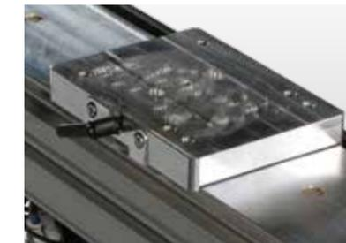
**Módulo de la placa base** para colocarse en la consola como base para los dispositivos de sujeción especiales
