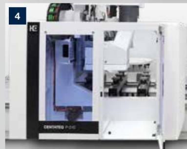
**Máxima visibilidad** en la máquina y, al mismo tiempo, protección óptima para el operario gracias a la gran ventana de control. Puede llevar a cabo el cambio de broca y el servicio en la parte delantera de la máquina de forma cómoda.
