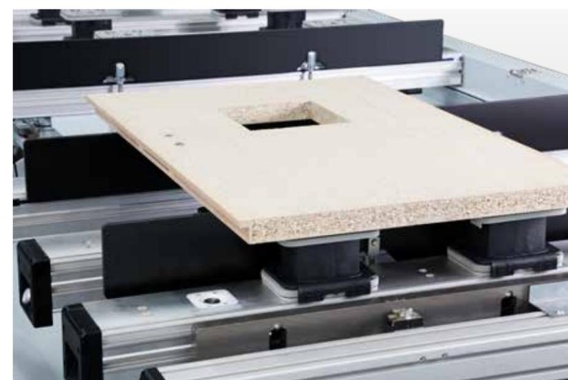
**Dispositivos auxiliares de colocación de piezas:** dispositivos robustos para la colocación de piezas más pesadas con 2 cilindros neumáticos. El movimiento lineal de los dispositivos auxiliares de colocación no separa las piezas de los topes al bajarlas, independientemente de si se mecanizan en los topes delanteros o traseros.
