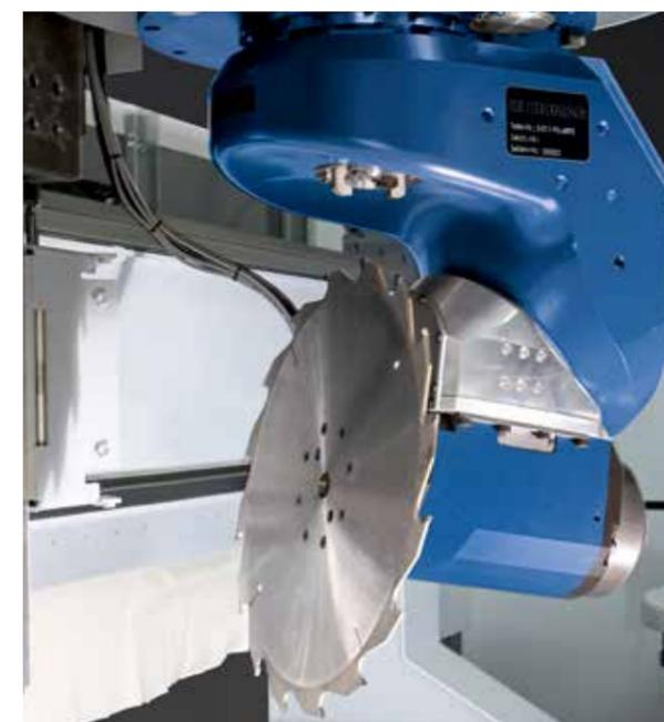
**Tête intelligente à 5 axes DRIVE5CS**, conception compacte et courses réduites. Une dose maximale de technologies dans un espace réduit, mais sans limitation des possibilités d'usinage. Broches refroidies par liquide dotées d'une puissance de fraisage de 10 kW (12 kW en option) pour un travail puissant. La conception compacte optimise l'espace de travail (si vous utilisez par exemple une lame de scie de 350 mm, sous le capot).
