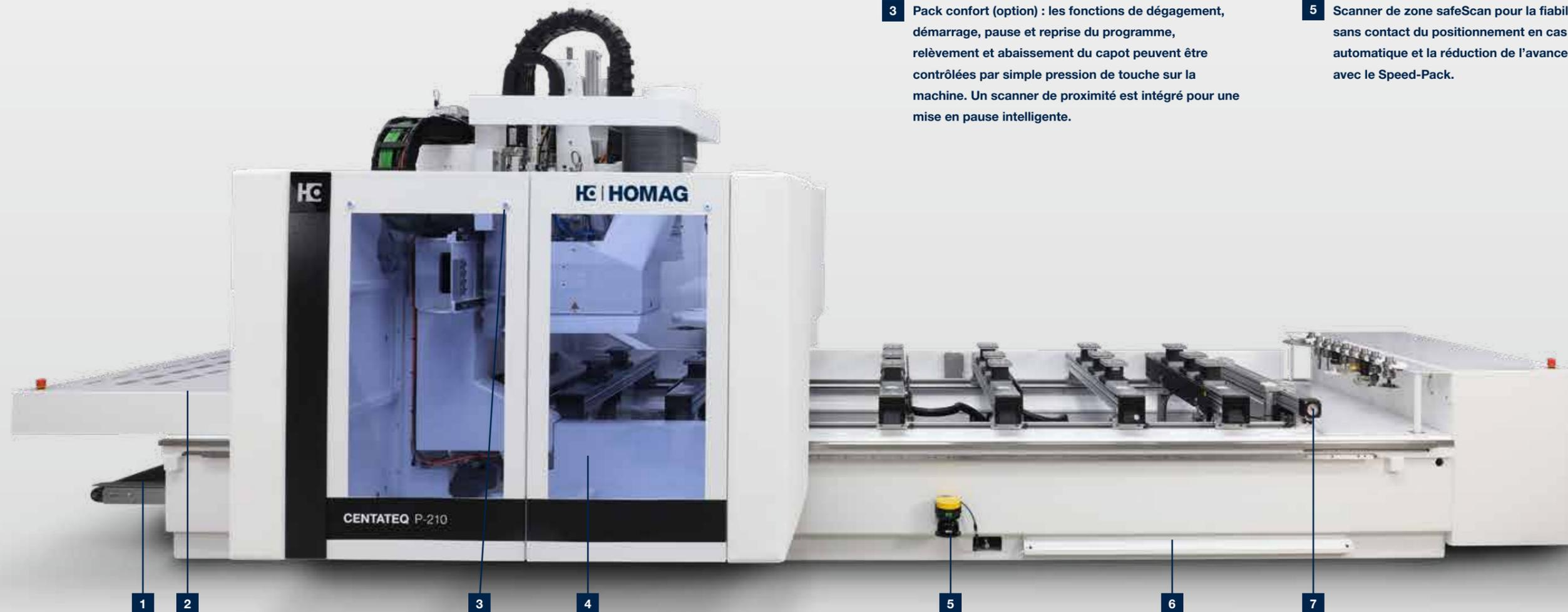
**1** Tapis de chutes (option) : élimination simple des restes et des copeaux grâce à un tapis de transport intégré. Un bac pour le rebut peut être poussé par l'avant contre la bande.
