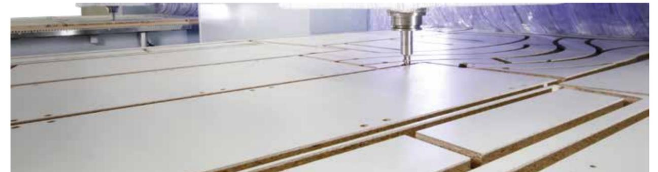
**Usage Nesting** de panneaux : découpe optimisée et usinage dans la surface
