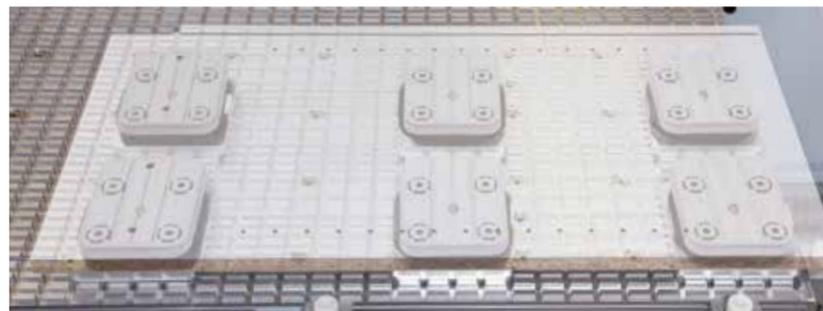
**Serrage par le vide** : éléments de serrage par le vide pour une utilisation dans les rainures de la table rainurée.
