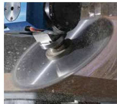
**Sciage, fraisage, perçage quelque soit l'angle – agrégat FLEX5+** avec réglage d'angle automatique. Un agrégat unique pour broches 4 axes qui couvre 90% des applications 5 axes.
