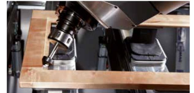
Usinage précis d'une feuillure pour l'insertion d'une vitre
