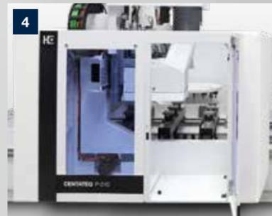
**4** **Vision parfaite** pendant l'usinage et protection optimale de l'opérateur grâce à une grande fenêtre. Changement de mèche et SAV peuvent se faire aisément par l'avant de la machine.
