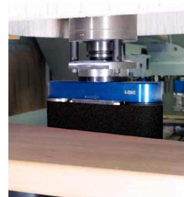
**Interface pneumatique** – Une interface avec un support 3 points sur tous les axes C et en option à la DRIVE5CS permet l'utilisation d'agrégats palpés pour un arrondissement supérieur et inférieur précis, indépendamment des tolérances en épaisseur.
