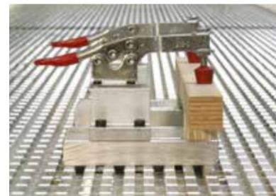
**Fixation d'éléments de serrage spéciaux** : la table rainurée en aluminium avec guidages à queue d'aronde garantit la fixation précise des éléments de serrage par complémentarité de forme.
