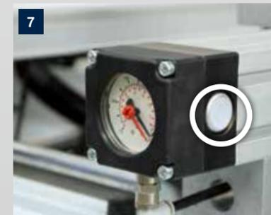
**7** **Bouton-poussoir pour le démarrage du programme** – un bouton-poussoir sur le profil de butée gauche et droit permettent le démarrage du programme d'usinage.
