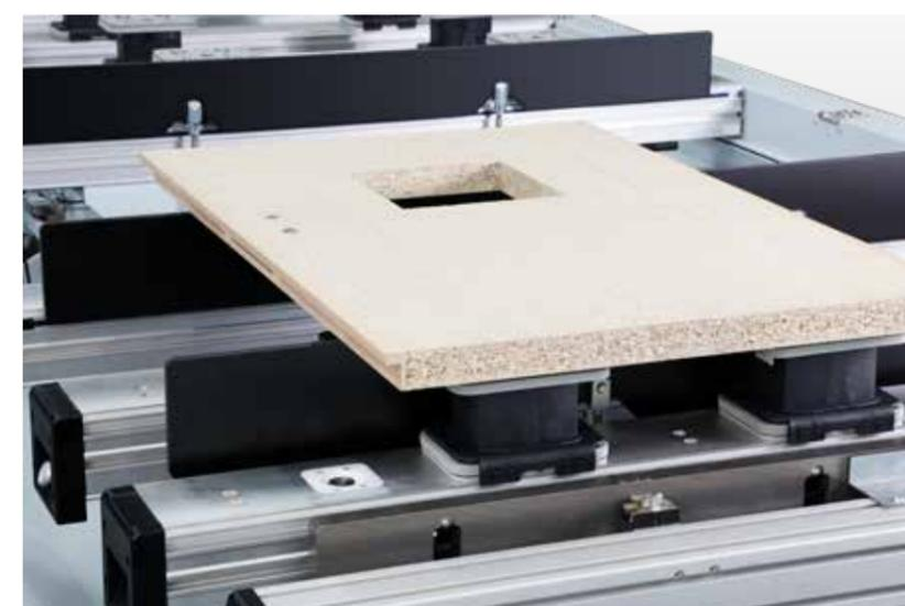
**Aides au positionnement** Aides au positionnement robustes pour l'introduction de pièces lourdes avec 2 vérins pneumatiques. Grâce au mouvement linéaire des aides au positionnement, les pièces ne s'éloignent pas des butées lors de l'abaissement, que l'usinage soit effectué sur les butées avant ou arrière.
