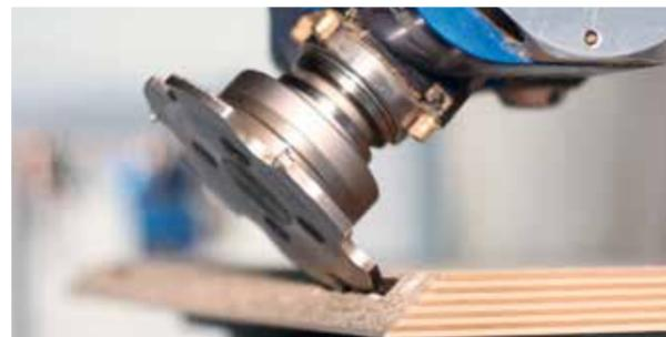
Fraisages pour ferrures d'assemblage
