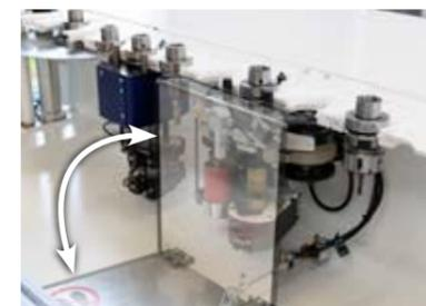
Interface électronique pour le changeur linéaire latéral pour le chauffage en simultané de l'agrégat d'encollage de chants.
