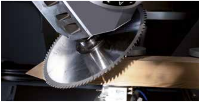
Угловые врубки при большой глубине реза при производстве деталей рамы
