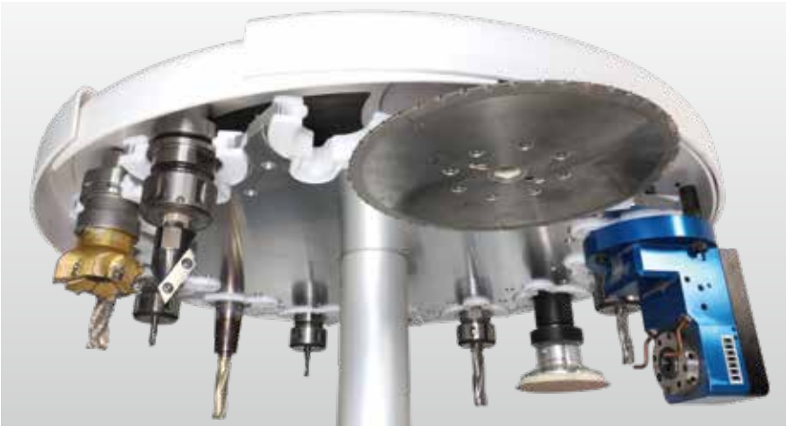
Дисковое устройство смены инструмента на 14 мест (синхронное перемещение по оси X). Также для пильных полотен диаметром до 300 мм.
