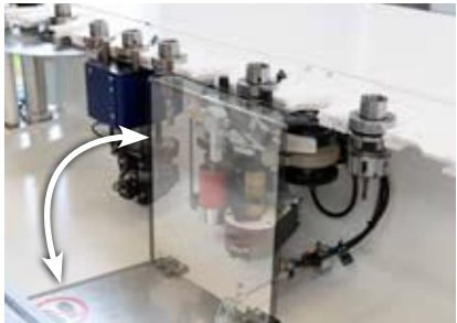
Elektroschnittstelle für den seitlichen Linearwechsler zum zeitparallelen Aufheizen des Kantenanleimaggregates.
