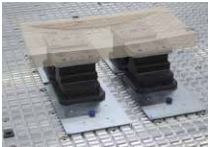
Система Maxi-Flex Свободно оснащаемые основные плиты для вакуумных присосок.
