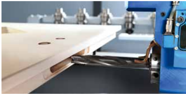
Фрезерование выборок под дверные замки
