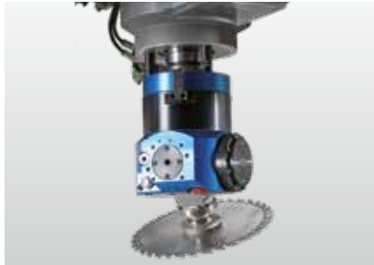
Rozszerzenie do FLEX5 (variant 4-osiowy) obejmujące złącze FLEX5 i agregat FLEX5
