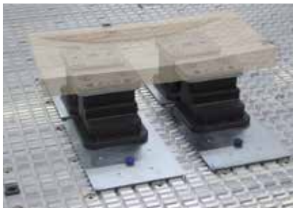
System Maxi-Flex – płyta podstawowa do ssawek podciśnieniowych z możliwością dowolnego wyposażenia
