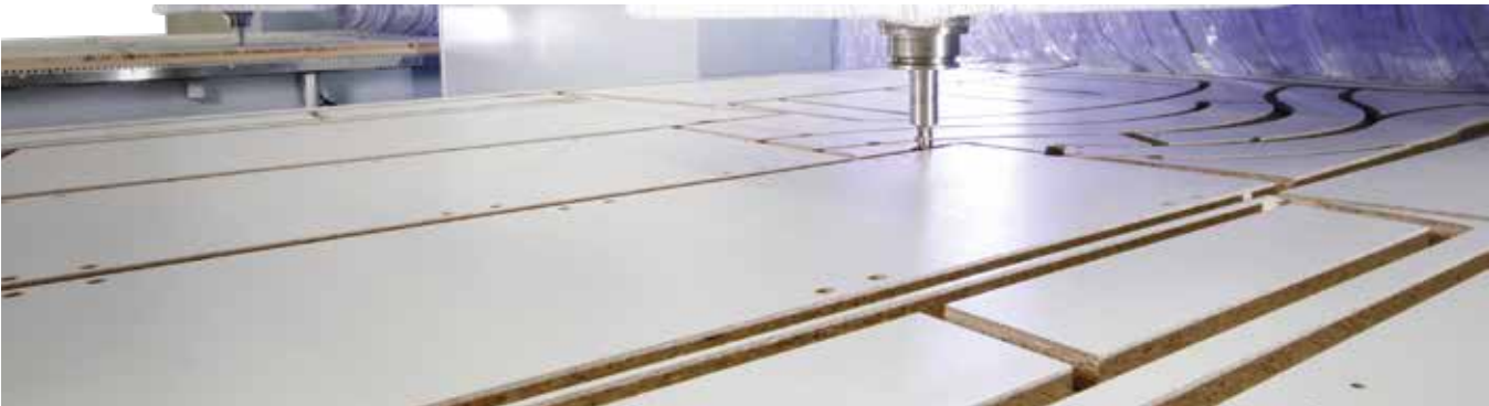
Obróbka w technologii nesting – zoptymalizowany rozkrój płyt i obróbka na powierzchni
