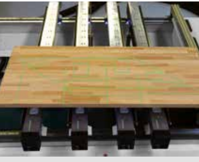
Projekcja laserowa elementów mocujących i konturu elementu w celu optymalnego wykorzystania materiału i ułatwienia układania elementów surowych, których nie da się wyrównać przy ogranicznikach
