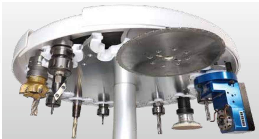
Magazynek talerzowy z 14 miejscami na narzędzia , przemieszczający się w osi X
