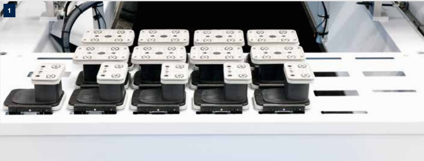
Miejsce do odkładania ssawek podciśnieniowych – z boku w maszynie znajduje się specjalne miejsce do odkładania ssawek podciśnieniowych gwarantujące szybki i wygodny dostęp do ssawek.
