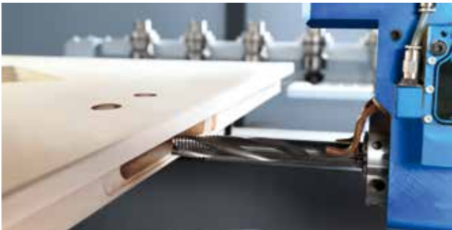
frezowanie kieszeni pod zamki
