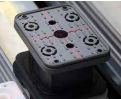
LASER do pozycjonowania (opcjonalnie): Za pomocą wiązki promieni laser wskazuje dokładne pozycje ssawek. Aby ułatwić pozycjonowanie elementów krzywoliniowych laser może także wyświetlać kontury elementu.
