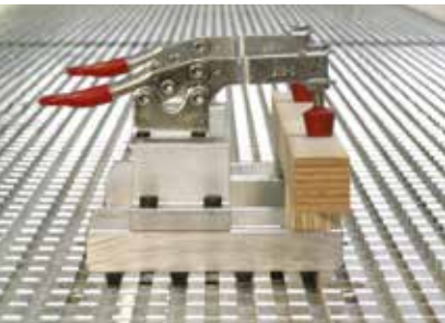
Montaż specjalnych elementów mocujących – aluminiowy stół rastrowy z przewodnikami na jaskółczy ogon pozwala na precyzyjny montaż specjalnych elementów mocujących
