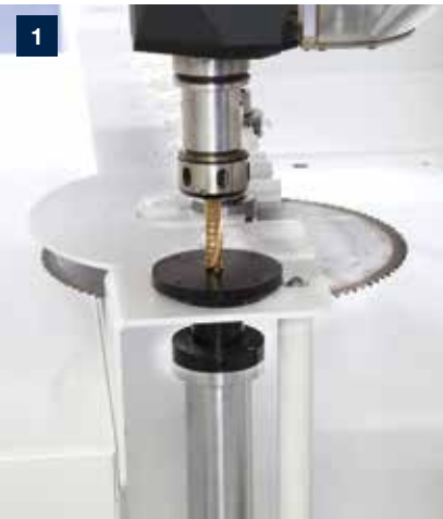
Kontrola délky nástroje (doplňkové vybavení) ▪ Vhodné pro měření délky stopkových nástrojů ▪ Po výměně nástroje se provádí kontrola délky a srovnává se s databází nástrojů
