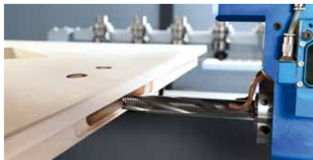
Vyfrézování dveřního zámku
