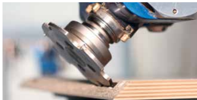
Vyfrézování otvoru pro spojovací kování
