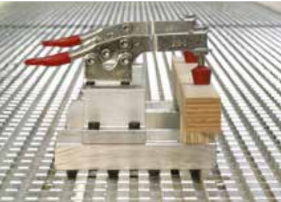
Speciální upínače hliníkový stůl zaručuje přesné upevnění nejrůznějších upínacích prvků
