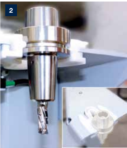
Místo pro základací místo nástrojů ▪ Bezpečné a rychlé doplňování zásobníku ▪ Snímač kontroluje obsazení místa pro předání a zajišťuje tak vysokou bezpečnost
