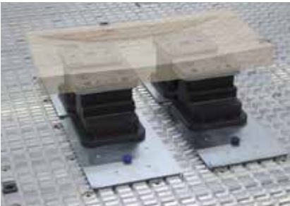
Systém Maxi-Flex volně polohovatelná podkladová deska pro vakuové přísavky
