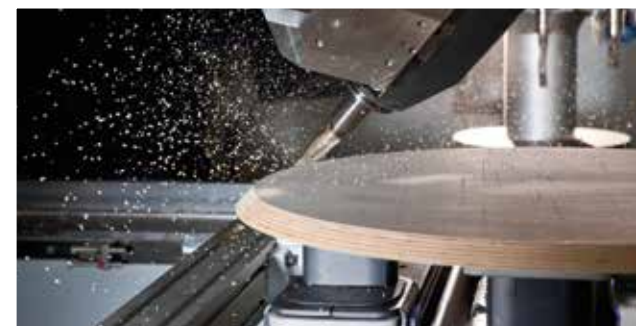
Frézování zkosené hrany na desce stolu
