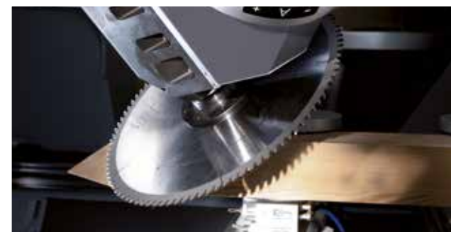
Skosený rez s velkou hloubkou rezu pro rámové díly
