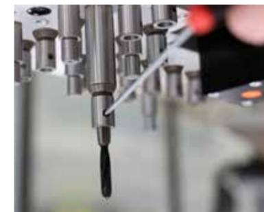
Weldon Wechselsystem für einen Bohrerwechsel mit Werkzeugen
