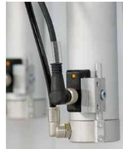
**Elektronische Endlagenabfrage** Erhöhte Sicherheit durch eine elektronische Endlagenabfrage an allen vorhandenen Anschlagzylindern
