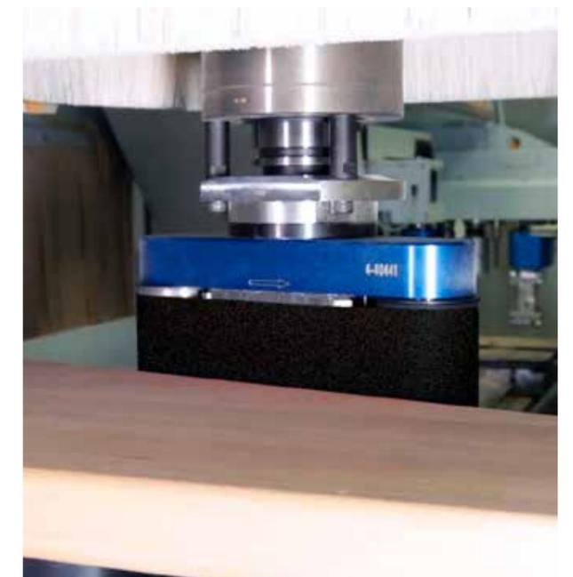
**Pneumatikschnittstelle** – die Schnittstelle mit 3-fach-Abstützung an allen C-Achsen und optional am DRIVE5CS ermöglicht den Einsatz getasteter Aggregate z.B. für exaktes Abrunden oben und unten unabhängig von Dickentoleranzen.
