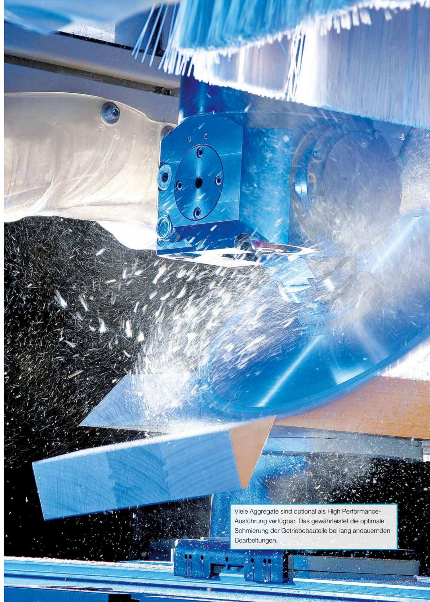
Viele Aggregate sind optional als High Performance-Ausführung verfügbar. Das gewährleistet die optimale Schmierung der Getriebebauteile bei lang andauernden Bearbeitungen.
