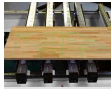
**Laserprojektion** der Spannmittel und der Werkstückkontur für optimale Ausnutzung und einfaches Auflegen von Rohteilen, die nicht an den Anschlägen ausgerichtet werden können.
