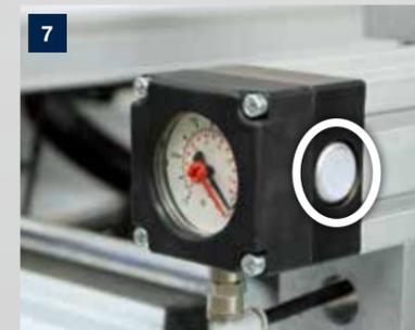
**Taster für den Programmstart** – Je ein Taster am linken und rechten Anschlagprofil dienen als Programmstart der Bearbeitung.
