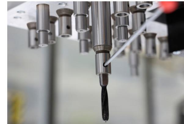
Weldon-Wechselsystem für einen Bohrerwechsel mit Werkzeugen
