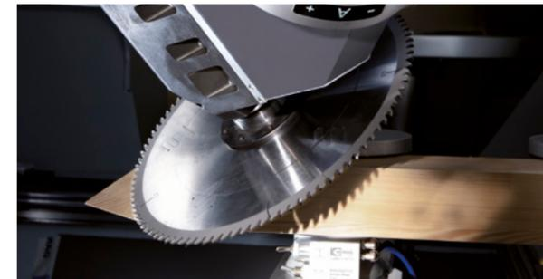
Schifferschnitt mit großer Schnitttiefe für Rahmenteile
