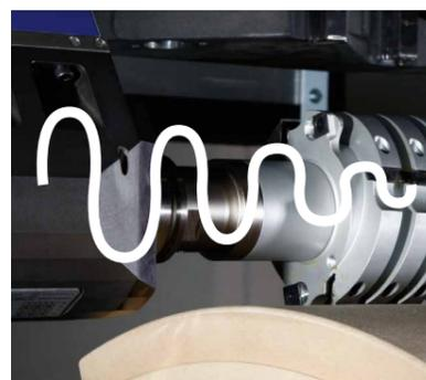
**Raffreddamento a liquido e sensore del mandrino (opzionale per DRIVE5CS):** i mandrini a fresare raffreddati a liquido con cuscinetto ibrido offrono una lunga durata. Un sensore di vibrazione aggiuntivo rileva lo sbilanciamento dell'utensile e protegge il mandrino da sovraccarichi, ad esempio dovuti a velocità di avanzamento eccessive.
