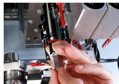
**Sistema di cambio rapido brevettato** per un cambio punta senza utensili per ridurre i tempi di attrezzaggio.
