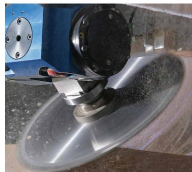
**Sezionatura, fresatura, foratura con qualsiasi angolazione: gruppo FLEX5** con regolazione automatica dell'angolazione. Un unico gruppo per mandrini a 4 assi che copre oltre il 90% delle applicazioni a 5 assi.
