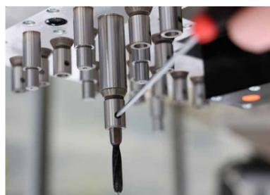
**Sistema di cambio Weldon** per un cambio punta con utensili
