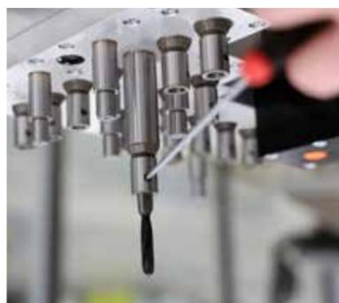
**Sistema di cambio Weldon** per un cambio punta con utensili
