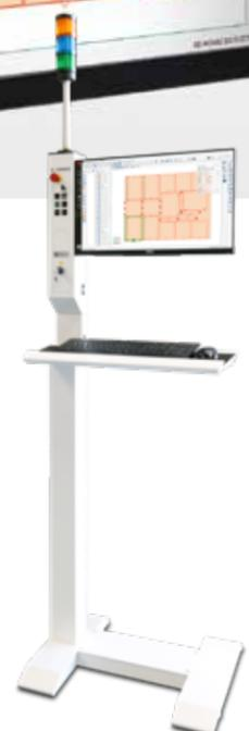
Il quadro di comando mobile con display multitouch full HD da 24" può essere spostato liberamente. A sinistra o a destra della macchina o per la messa a punto direttamente davanti alla macchina: il quadro è sempre al posto giusto.
