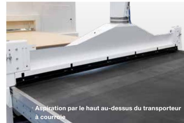
Aspiration par le haut au-dessus du transporteur à courroie
