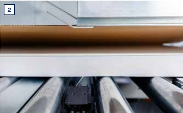
Applicazione colla nel lato longitudinale - in esercizio continuo vengono applicate sul lato longitudinale del cartone, a seconda dell'altezza del cartone, 1 o 2 tracce di colla termofondente.
