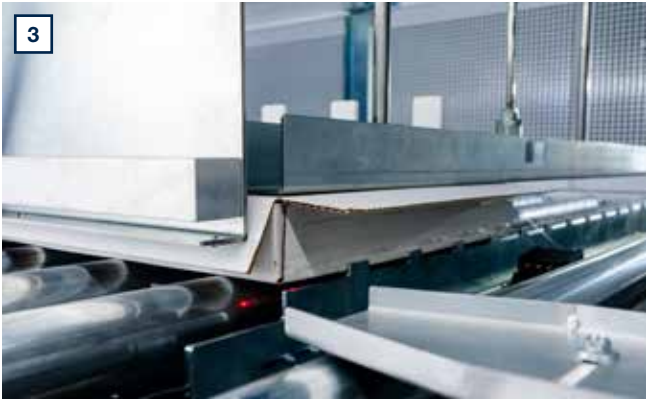
Applicazione colla lato trasversale anteriore - i pacchetti vengono posizionati e arrestati sul bordo anteriore. Mediante un ugello mobile, la colla termofondente viene applicata sul lato trasversale anteriore.
