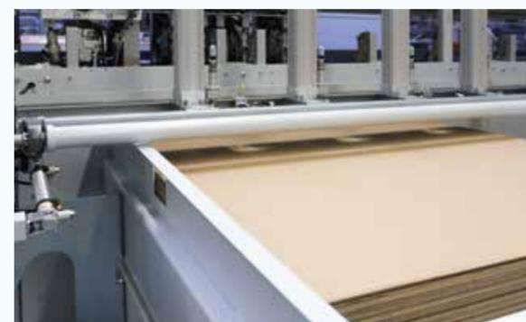
Die **Einzelblattzuführung** ermöglicht die Zuführung einzelner Verpackungsblätter sowie die Verwendung von Endloskartonagen ohne Haspel.
