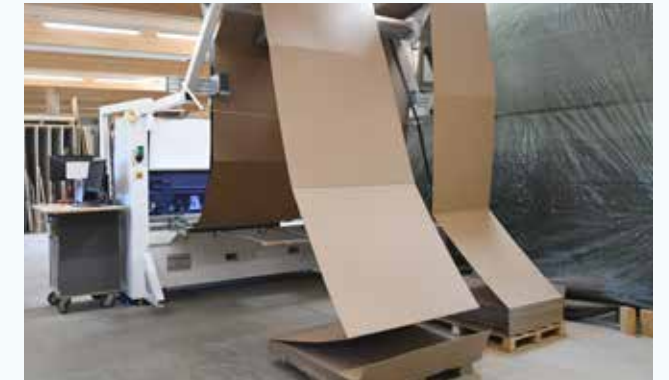
Naudojant gamybos sąrašus kartono ruošinių gamyba vyksta automatiškai. Galima nutraukti procesą atliekant atskirus individualius pjūvius ir „nepamirštant“ paskutinių nustatymų.
