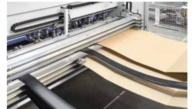
Ruloninio kartono tiekimo keitiklis yra automatinis keitiklis begaliniam konvejerio pločių skaičiui su iki šešių skyrių.
