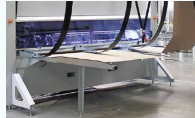
Kombinuotas kartono žaliavos tiekimas sudaro sąlygas pavieniams lapams tiekti ir naudoti ruloninį kartono tiekimą.
