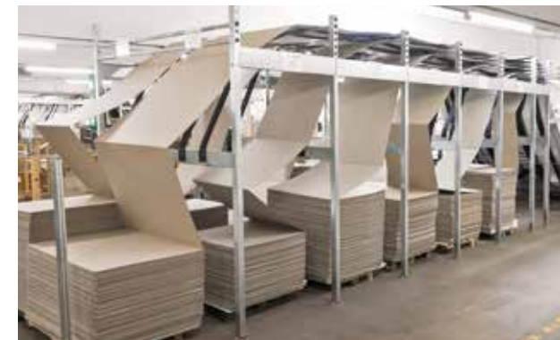
Darbo režime „ Side-by-Side “ kartono tiekimo skyrius išplečiamas papildomu konvejerio pločiu, kad 6 skyrių keitiklio sistemose būtų iki 12 konvejerių pločių per vieną prieigą.
