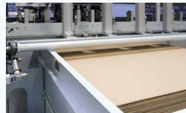
Pavienių lapų tiekimas sudaro sąlygas pavieniams pakuotės lapams tiekti ir ruloniniam kartono tiekimui naudoti be ritės.
