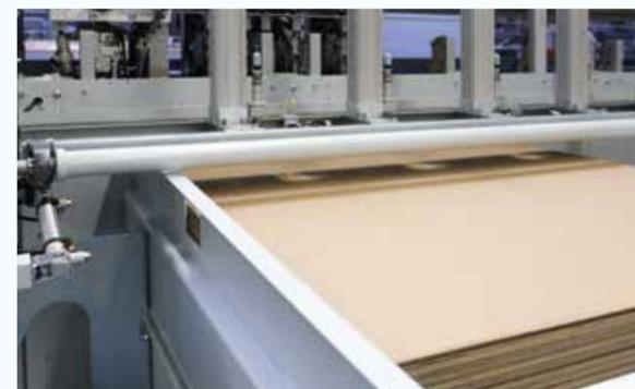
L'alimentazione di fogli singoli permette l'alimentazione di singoli fogli di imballaggio e l'utilizzo di cartonaggi continui senza aspo.
