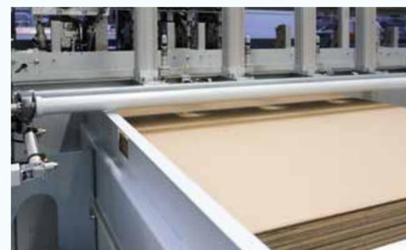
L'**alimentation de plaque individuelle** permet d'amener des plaques d'emballage individuelles et d'utiliser des cartons en bandes sans enrouleur.
