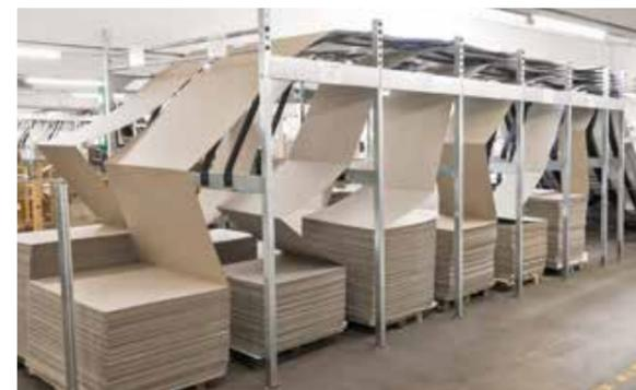
En mode de fonctionnement **side-by-side**, le compartiment d'alimentation des cartons est agrandi d'une largeur de bande supplémentaire, de sorte que, dans le cas d'un système de changement à 6 emplacements, jusqu'à 12 largeurs de bande puissent être accessibles individuellement.
