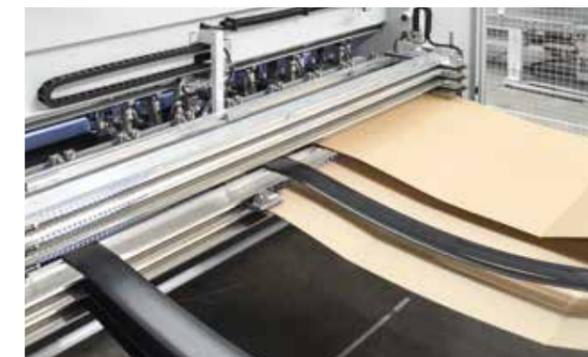
Le **changeur de cartons en bandes** est un système de changement automatique pour les largeurs de bande sans fin qui comprend jusqu'à six compartiments.
