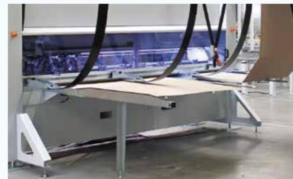
Le **système combiné d'alimentation de cartons** permet d'amener des plaques individuelles et d'utiliser des cartons en bandes.
