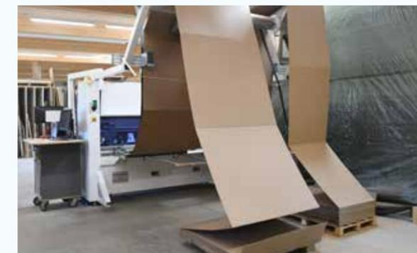
Si se utilizan **listas de producción**, la fabricación de los cartones se realiza de forma automática. Es posible interrumpir el proceso con algunos cortes específicos sin que la máquina "olvide" los últimos ajustes configurados.
