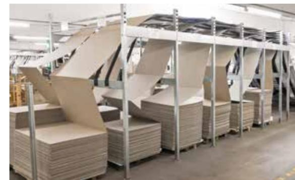
En el modo de funcionamiento **side by side**, el compartimento de alimentación de cartón se amplía en una anchura de cinta adicional, de modo que en un sistema de cambio de 6 compartimentos se pueden tener hasta 12 anchuras de cinta a las que se puede acceder de forma individual.
