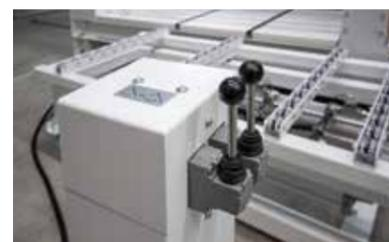
**Funzionamento del dispositivo per la messa in verticale dei mobili:** semplicemente tirando una leva, il dispositivo solleva il mobile pressato finito.
