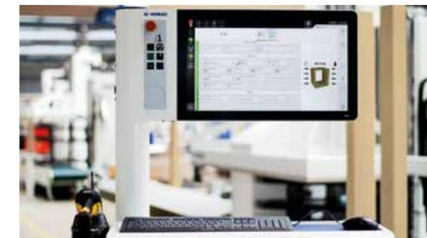
**Manejo sencillo:** El manejo es sencillo e intuitivo. Las funciones integradas de ayuda y asistencia facilitan el trabajo. El operario puede introducir rápida y fácilmente ajustes, como el tiempo o la presión de prensado, a través de un monitor táctil.
