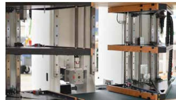
**Caras de prensado laterales:** Las caras de prensado funcionan como una sola unidad. Las fuerzas de prensado se generan eléctricamente y se pueden ajustar por separado. Se aplican verticalmente mediante una placa de prensado y horizontalmente mediante 3 caras de prensado.
