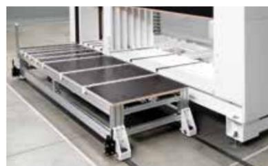
**Plataforma de preensamblaje deslizante:** La plataforma de preensamblaje facilita el ensamblaje de los cuerpos a la altura de trabajo de la prensa.
