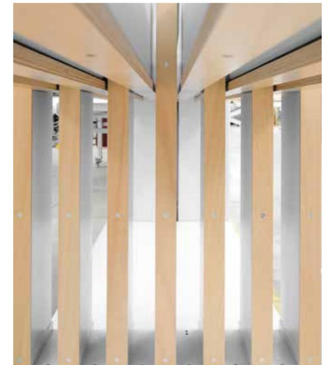
**Superficies de prensado con compensación de tolerancia:** Las láminas de prensado funcionan como una sola unidad y van montadas sobre rodamientos de goma con efecto amortiguador. Dado que las láminas de prensado llegan al mismo tiempo al cuerpo, la presión se reparte muy uniformemente y las tolerancias en el cuerpo se absorben mejor.
