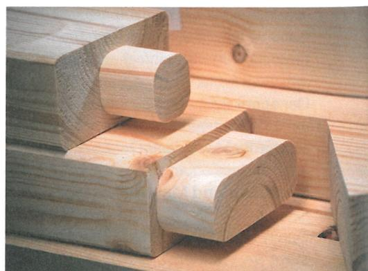
Bauteile wie beispielsweise diese Zapfen werden mit einer hohen Passgenauigkeit hergestellt
