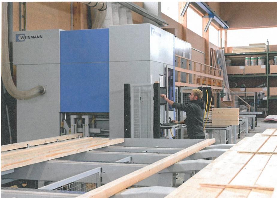
Die kompakte Bauweise der Abbundanlagen ermöglicht eine einfache Positionierung in der Halle
